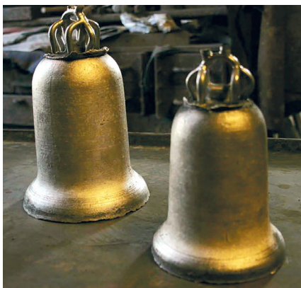
Fig. 5 : Les deux cloches d'essai après nettoyage
